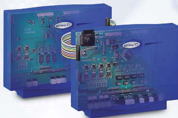
Durch Anschaltung des Erweiterungsgehäuses elmeg ICT880xt bietet dieses System bis zu 88/118 Ports. Alle bekannten elmeg-Module und Endgeräte sind kompatibel und können auch in Zukunft weiter eingesetzt werden.
